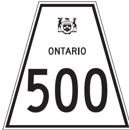
(d) M107 – Secondary Provincial Route Marker
